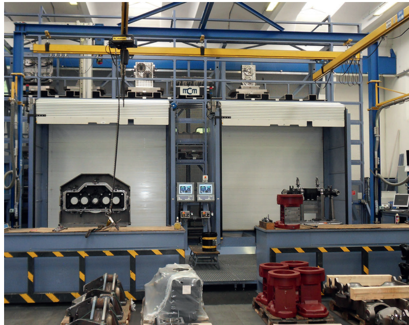
3 Be- und Entladestationen bei einem FFS von MCM, im Einsatz bei einem Getriebehersteller (© Hanser)
